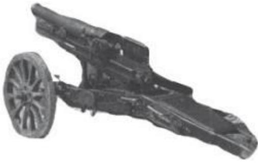
Da cannone da Montagna a cannone di accompagnamento per la fanteria, il 65/17 aveva una gittata di 6.500 metri. In dotazione al regio Esercito era scomponibile in 5 carichi: cannone - testata - slitta e freno - coda e ruote - scudi.
